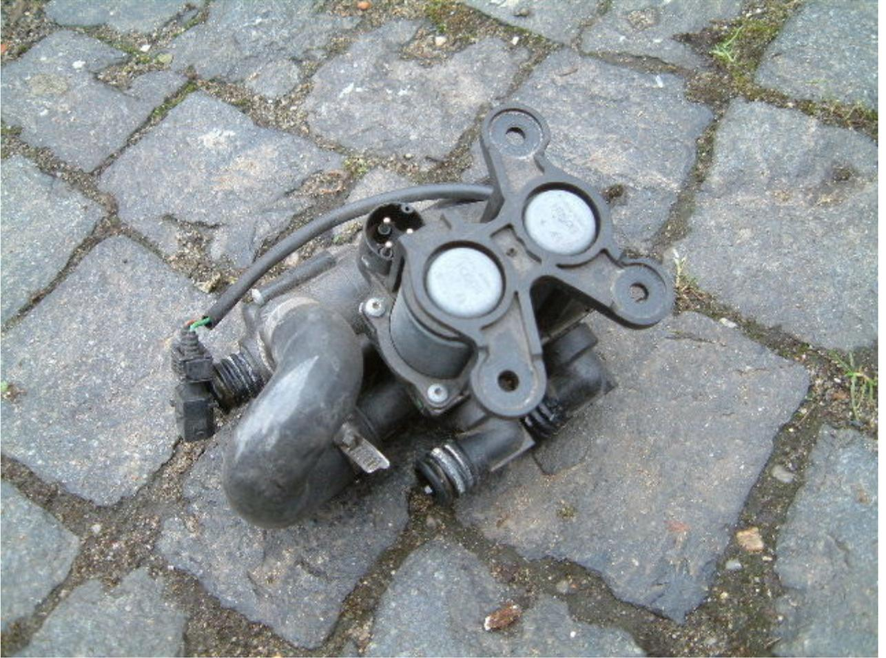
Das war schon alles. Man hat die Einheit draussen, löst die eine Schlauchschelle von der Pumpe, schraubt diese lose mit dem Torx, die neue rein und Vorsicht mit den Kabeln, festschrauben und Einbau in umgedrehter Reihenfolge.
