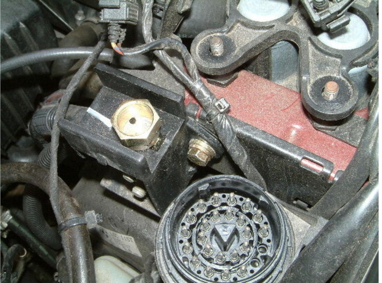
Dann löst man zuerst den Schlauch der von unten kommt. Man hebt dann die Einheit mit den Heiznetzielen von den Gummifüßen ab, schiebt diese etwas nach vorn, um den oberen der beiden übereinanderliegenden Schläuche zu lösen. Wenn dieser weg ist die Einheit ganz in Richtung Fahrzeugmitte herüberschieben und den dritten und letzten Schlauch lösen. Dabei merken wo welcher Schlauch war und wie der Gaszug verlegt ist!!, danach sieht es so aus:
